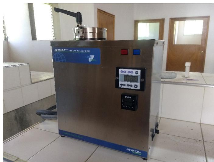
Fig. 9. Appareil de détermination des fibres
