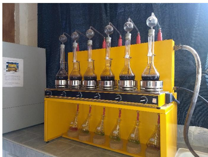
Fig. 8b. Distillateur Djeldahl
